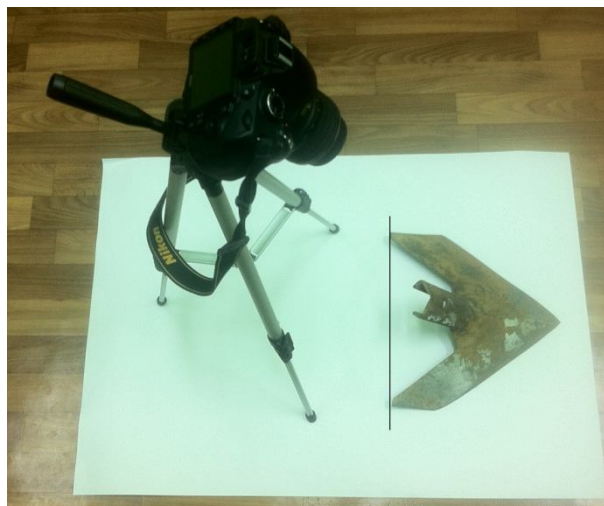
Рисунок 2. Фотографирование изношенной лапы
