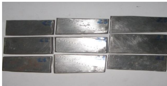
Рисунок 3. Фрагменты раскроя средней области отвала (образцы, подготовленные к испытаниям)
