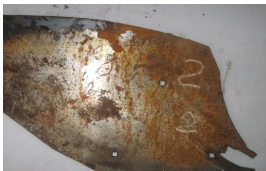
Рисунок 1. Отвал, исчерпавший ресурс вследствие сквозного протирания в области носка
