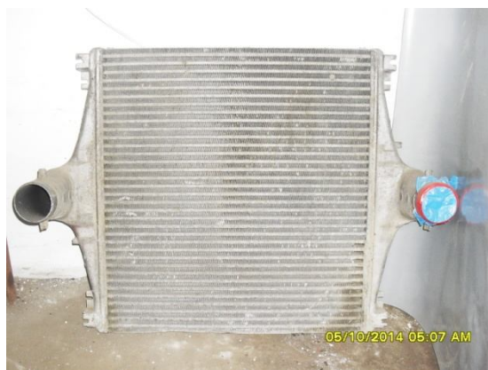
Рисунок 4. Радиатор (интеркулер) импортного производства после ремонта
