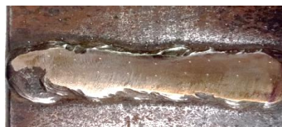
Рисунок 2-Измерение твердости наплавленного валика (а-схема измерений; б-натурный образец)
