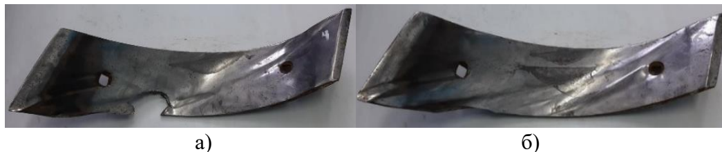
Рисунок 4 - Дефекты вертикальных ножей ( а) - лучевидный износ и износ режущей части; б) - лучевидный износ с его изломом; в) - лучевидный износ с местным разрушением)
