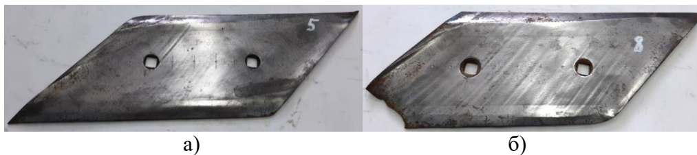
Рисунок 2-Дефекты левых ножей (а-лучевидный износ рабочей поверхности, износ лезвия; б-лучевидный ихнос рабочей поверхности, и разрушение заглубляющей части)
