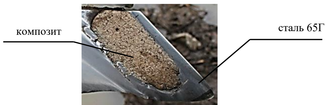
Рисунок 1 - Состояние поверхностей композита и металла детали после эксплуатации (долотообразная часть плужного лемеха после вспашки 10 га супесчаной почвы)
