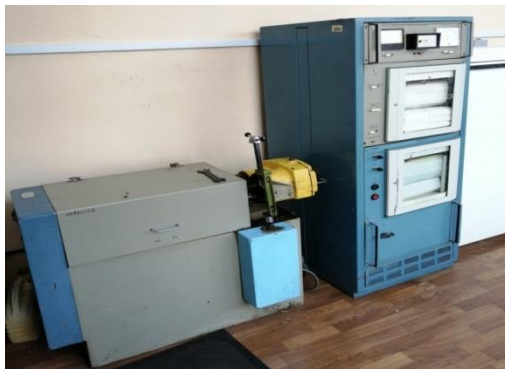
Рисунок 2 - Машина трения СМТ-1
