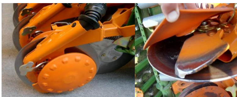
Рисунок 5 - Однодисковый сошник «Rotek»
