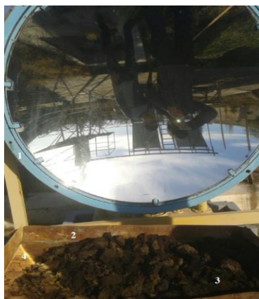
Рисунок 1. Опытная установка для обработки обезвоженной осадки 1. концентратор, 2. приспособления из железного листа, 3. осадки
