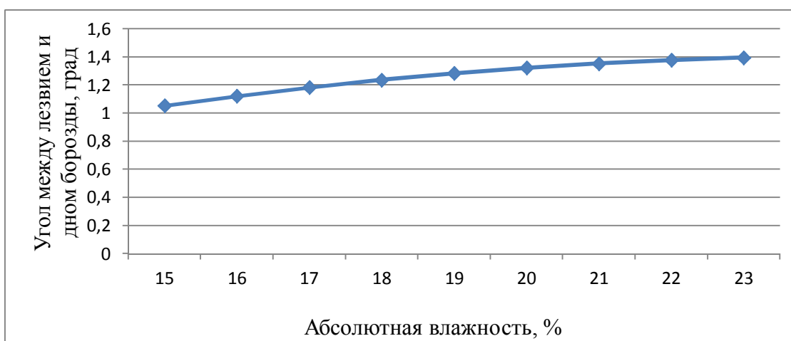
Рисунок 4. Соответствие угла между лезвием крыла стрелчатой лапы и дном борозды от значений абсолютной влажности
