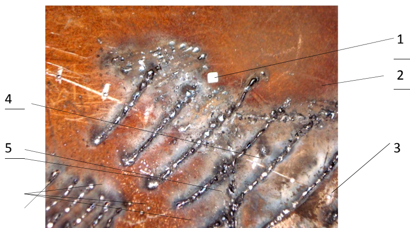
Рисунок 2. Отвал со вставкой, армированный, с заправкой лучевидного износа 1-заплавленный лучевидный износ; 2-отвал; 3-сваренная вставка; 4-просверленные контролирующие отверстия; 5-наплавленные армирующие валики
