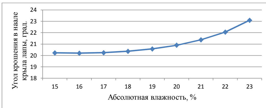
Рисунок 2. Соответствие угла крошения стрелчатой лапы от абсолютной влажности
