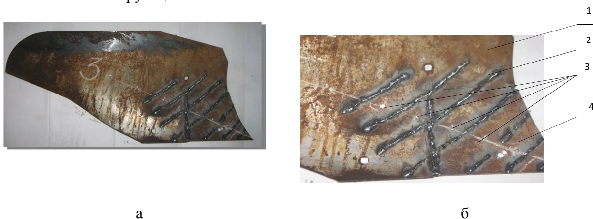
Рисунок 2. Отвал со вставкой, армированный, с заправкой лучевидного износа 1-заплавленный лучевидный износ; 2-отвал; 3-сваренная вставка; 4-просверленные контролирующие отверстия; 5-наплавленные армирующие валики
