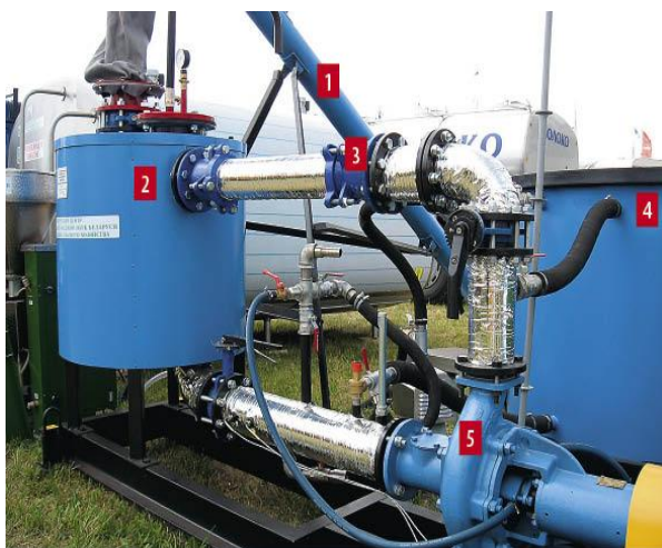
1 – транспортер с весоизмерительным устройством для приема и подачи зернофуража; 2 – агрегат влаготепловой обработки; 3 – турболизатор; 4 – смеситель приготовления ЗЦМ; 5- насос подачи приготовленного ЗЦМ
