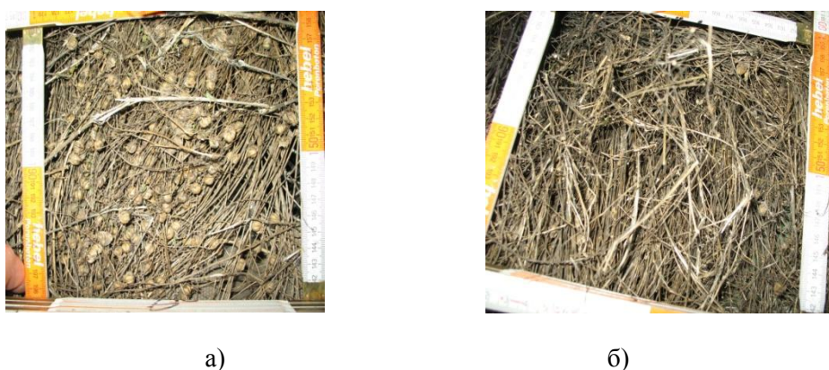
Рисунок 2 – Обмолачиваемая лента льна: а – до обмолота; б – после обмолота
