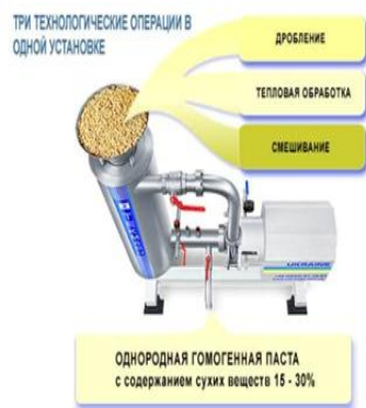
Рисунок 2 – Установка для приготовления влажных кормовых смесей ТЕК-СМ
