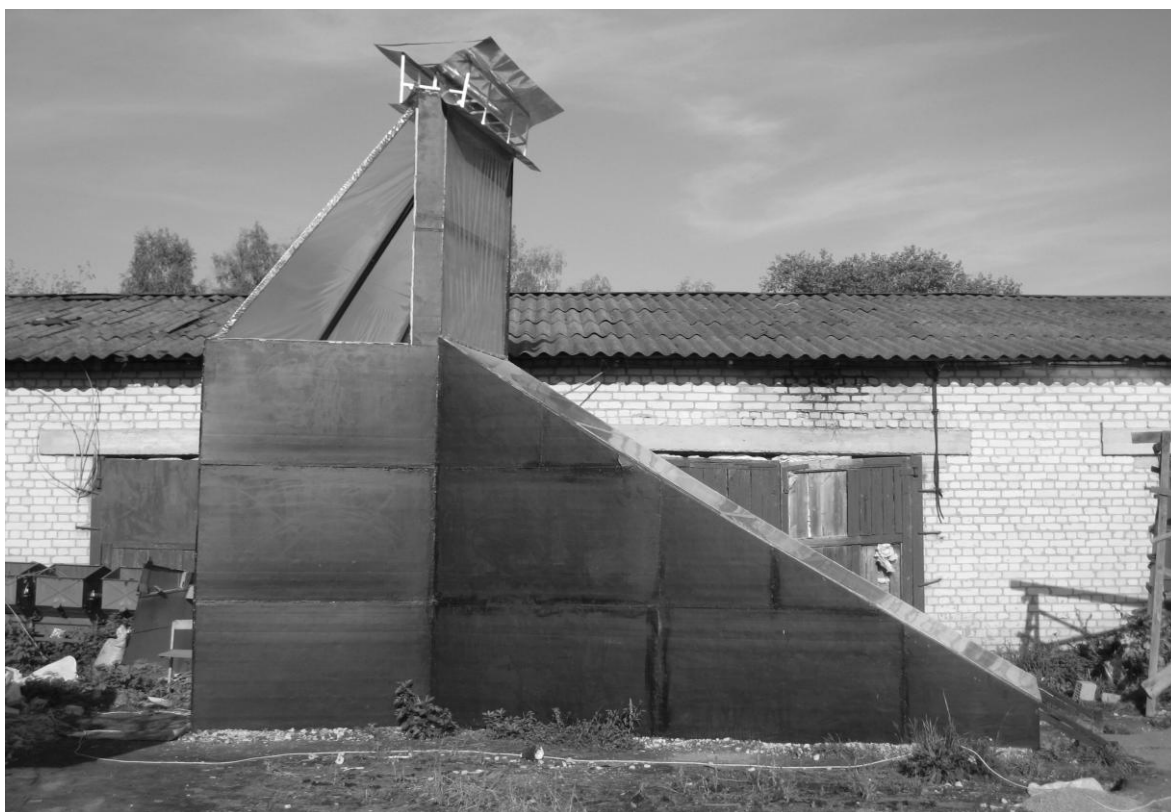
Рис. 1. Барабанная гелиосушилка зерна
