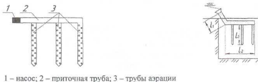
Рисунок 2 – Система аэрации для компостного бурта или приямка
