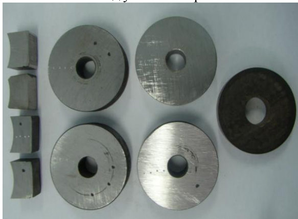
Рис. 2. Алмазный круг АСО 125/100 100% М1 (тёмный) и образцы из стали У10
