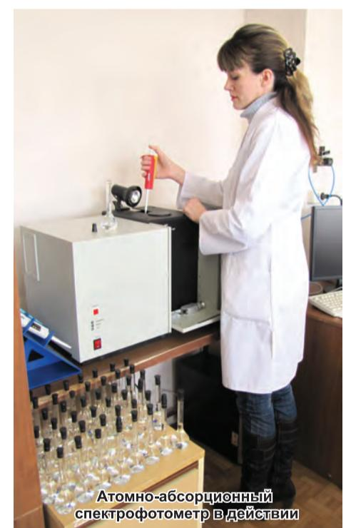
Атомно-абсорбционный спектрофотометр в действии
