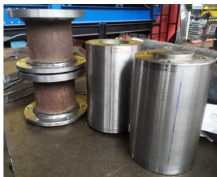
Рисунок 6 – Экспериментальные образцы ступичных удлинителей
