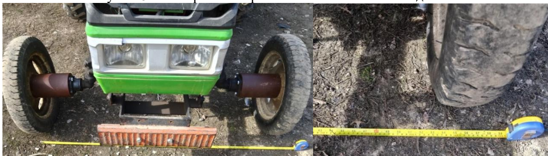
Рисунок 9 – Измерение ширины колесной колеи на передней оси
