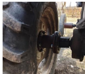
Рисунок 7 – Установленные удлинители на одной из сторон трактора
