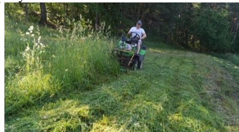
Рисунок 11 – Проведение динамических полевых испытаний на склоне
