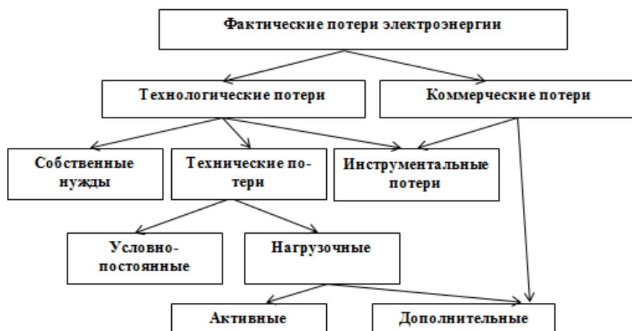
Рисунок 1 - Структура потерь электроэнергии в распределительных сетях напряжением 6-10/0,4 кВ
