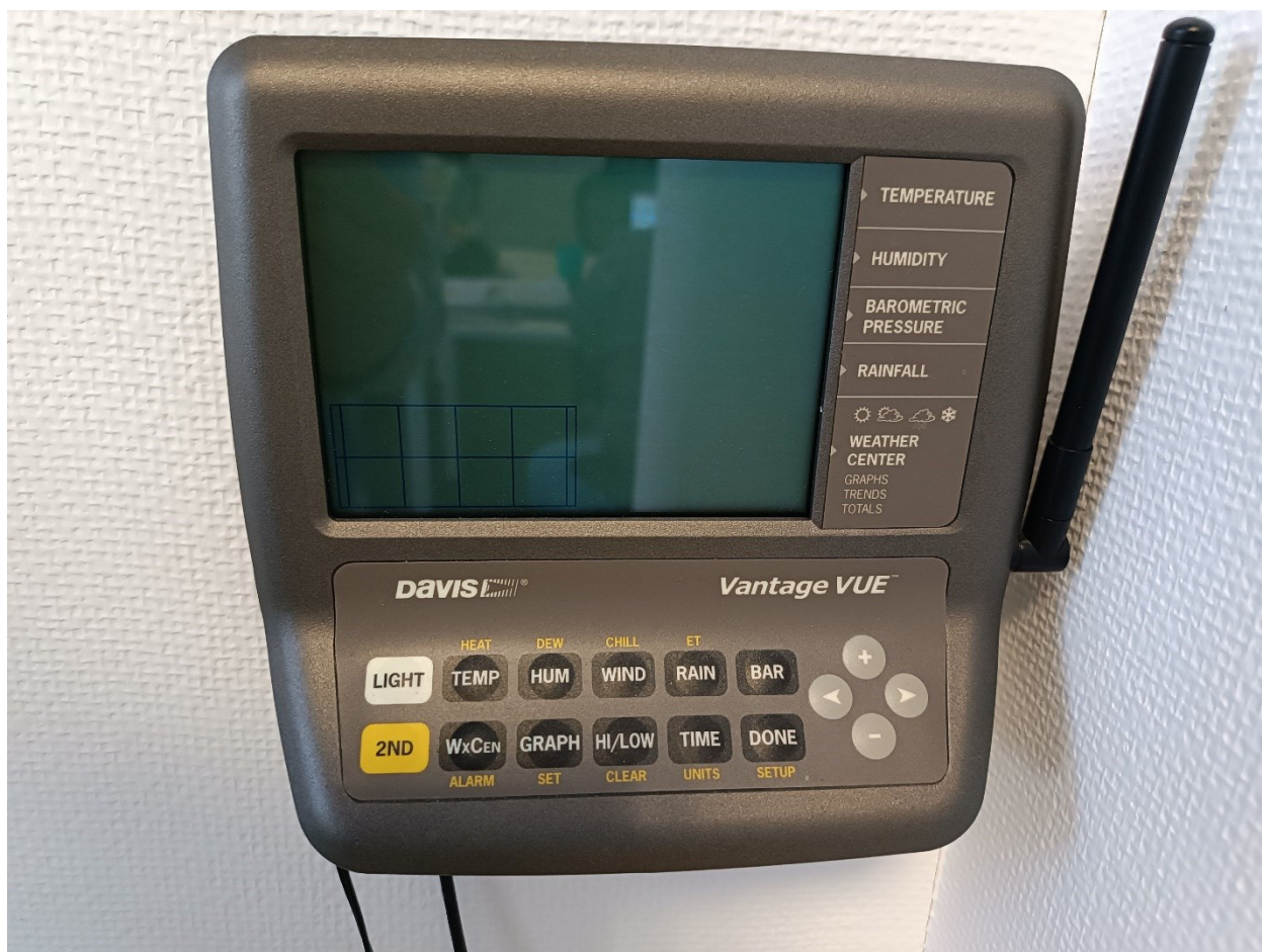
Рис. 1. Вид основного дисплея беспроводной метеостанции DAVIS Instruments Vantage VUE 6250EU
