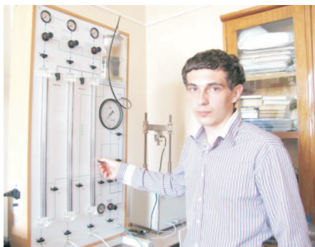
Аспирант Николай Чемисов у «стабилометра» - прибора трёхосного сжатия
