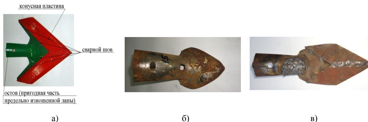
Рисунок 4 – Восстановленная лапа комплекса «Моррис» (а – для посева по стерне; б – лапа для посева по подготовленной почве, в – комплексно восстановленная лапа)
