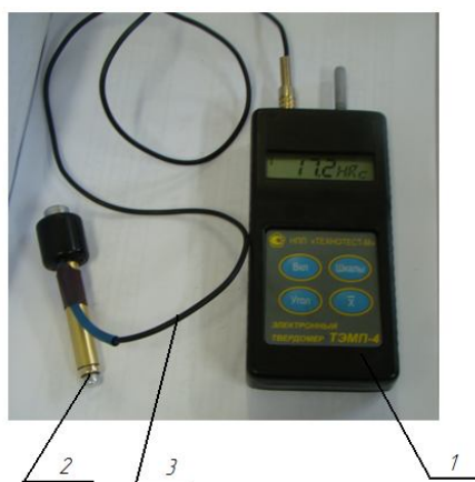
1 – корпус электронного блока, 2 – датчик, 3 – экранированный кабель
