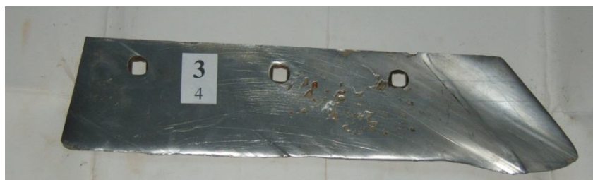
Рисунок 2 – Опытный лемех после наработки 14 га
