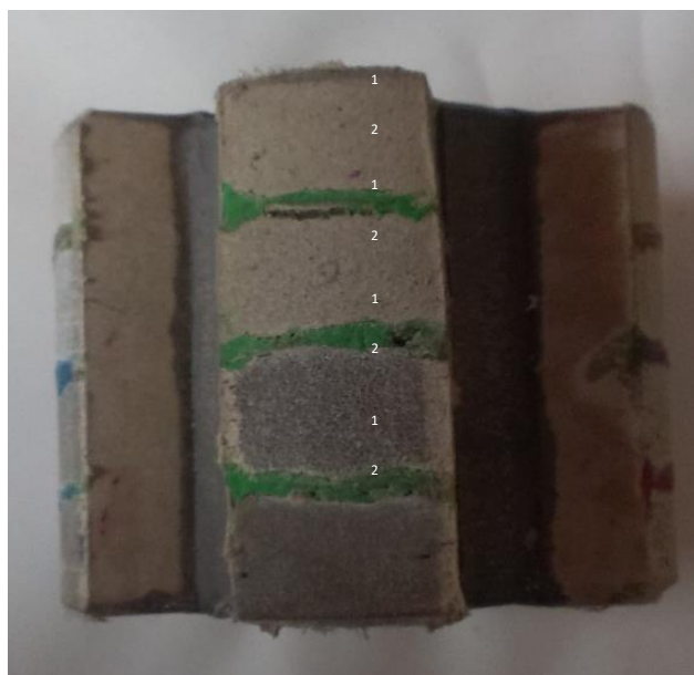
Рисунок 3 - Схема измерения твердости
