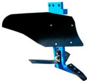
Рисунок 1 – Модернизированный корпус плуга
