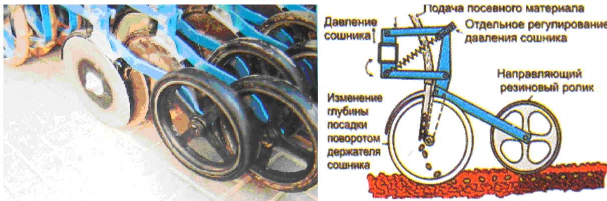
Рисунок 3 - Двухдисковый сошник с направляющим резиновым роликом
