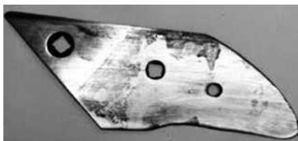
Рисунок 3 - Износ полевого обреза долот производства фирмы «Лемкен»
