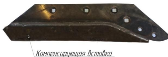
Рисунок 1 - Восстановленный лемех компании «КУН» с термоупрочненной компенсирующей вставкой (режущей-лезвийная часть)
