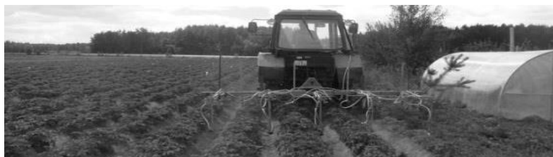
Рисунок 4 – Опрыскивателя с телескопическими секциями для ленточного или объемного внесения рабочих растворов в работе
