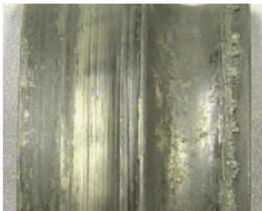
Рисунок 6 - Выявленный износ подшипника качения
