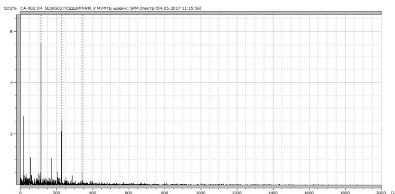
Рисунок 7 - Дефект внутренней обоймы подшипника FAG 6234
