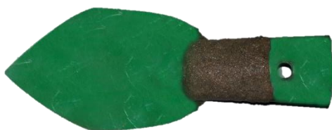
Рисунок 2 – Восстановленная стойка культиваторной лапы при помощи дисперсного композиционного материала
