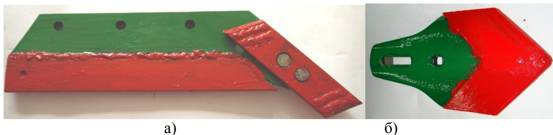
Рисунок 3 – Восстановленный методом ТКЭ: а) - составной лемех компании «Фогель и Ноот»; б) – культиваторная лапа компании «Амазоне»
