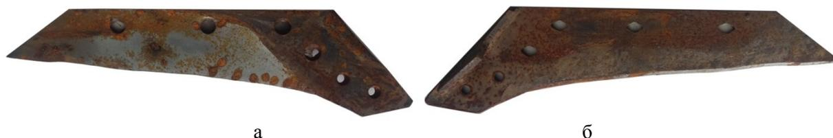
Рисунок 4 – Лемех после удаления грубых загрязнений (а и б – лицевая и тыльная стороны соответственно)
