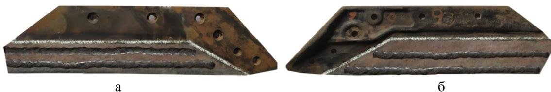
Рисунок 11 – Восстановленный лемех с упрочняющим наплавочным армированием (а и б – лицевая и тыльная стороны, соответственно)
