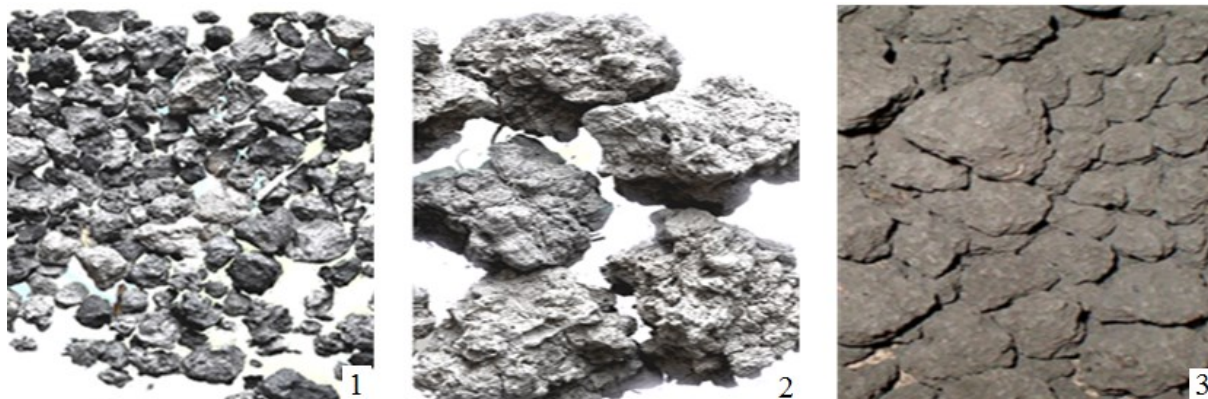
1 – зернистые (0,05-5 мм); 2 – комковатые (5-50 мм); 3 – глыбистые (50-100 мм и более) Рисунок 3 – Виды структурных агрегатов агрогоризонта почвы.
