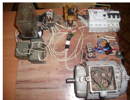
Рисунок 1. Рабочий макет установки контроля сопротивления изоляции.
