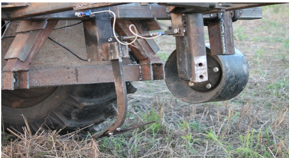
Рис. 4. Лабораторная установка со стрельчатой лапой
