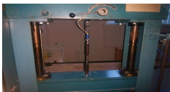
Рис. 5. Тарировка тяги на лабораторной установке РМ - 0,5
