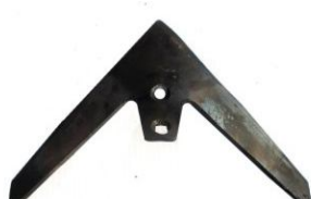
Рис. 2. Лапа стрельчатая универсальная с переменным углом крошения
