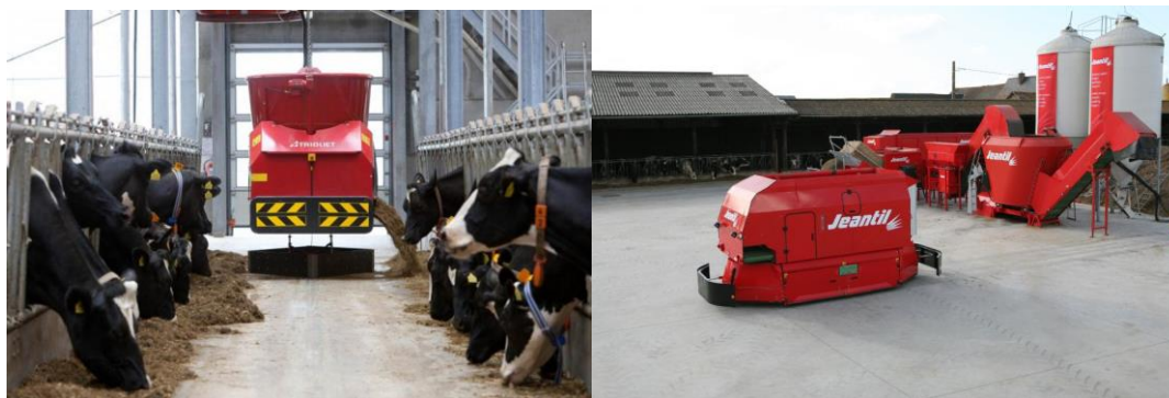
Рис. 3. Подвесной кормовагон Triomatic HP 2 300 (слева); кормовагон на шасси Jeantil Automatic Feeding (справа)
