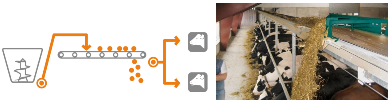
Рис. 2. Схема работы (слева) и общий вид ленточного кормораздатчика GEA Belt Feeder (справа)
