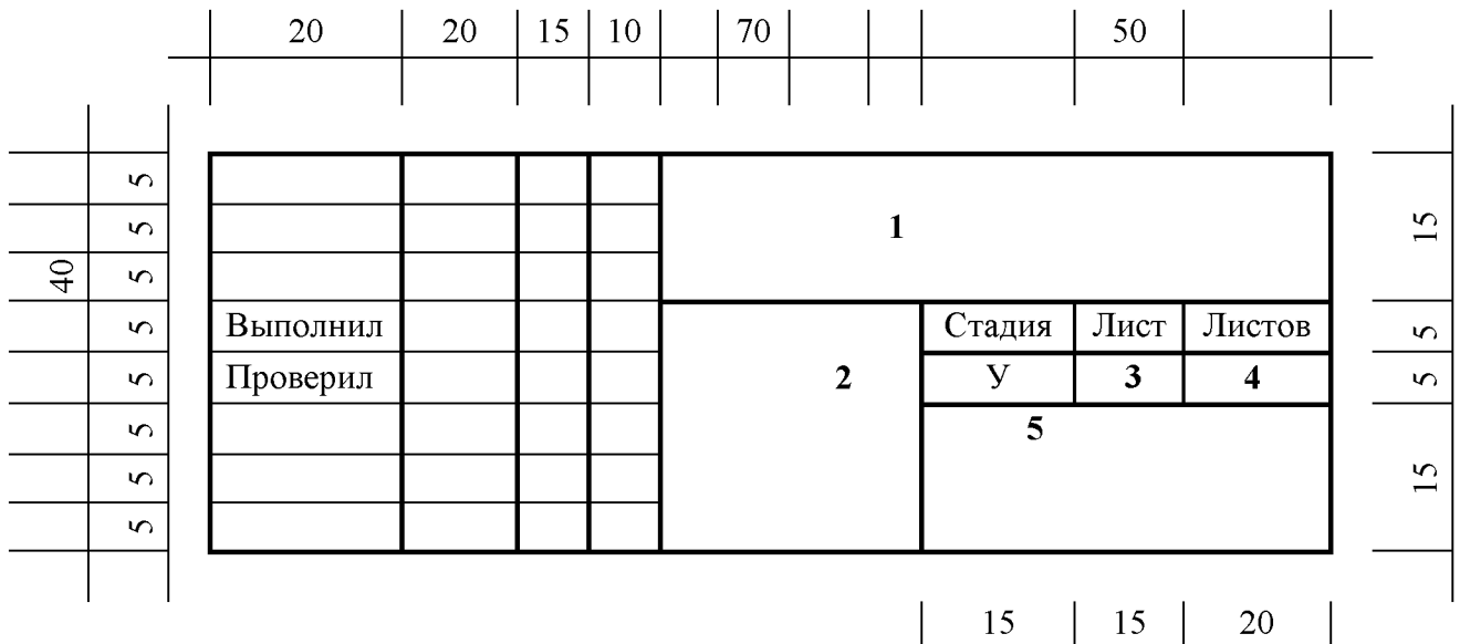
Рисунок 1 - Основная надпись размером 180x40мм на листах пояснительной записки
